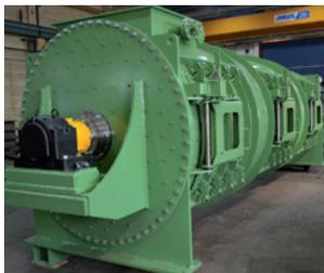
Horizontalmischer mit Verschleißschutzauskleidung
